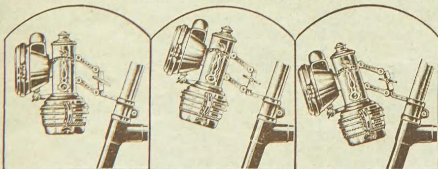
Die richtige Befestigung der Lampe am Rade ist eine Hauptbedingung für deren vollkommene Lichtwirkung. Der Laternenhalter muss genau senkrecht stehen. Die beige-setzten Zeichnungen veranschaulichen sowohl die falsche, wie die richtige Stellung der Lampe.
