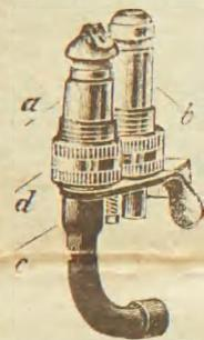
Jeder einzelne Brenner, sowohl Haupt- wie Ersatzbrenner, ist ferner noch ohne Zuhilfenahme irgend eines Werkzeuges auswechselbar! Das Auswechseln geschieht dadurch, dass man die den Brenner, festhaltende Ueberwurfmutter *d* losschraubt, den verstopften Brenner herausnimmt und ihn gegen einen neuen ersetzt.
