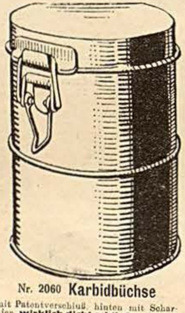
Nr. 2060 Karbidbüchse mit Patentverschluss hinten mit Scharnier wirklich dicht schließend , auch zum Aufbewahren v. Fett, Gummilösung usw., sehr sauber u. dauerhaft, gearbeitet innen schwarz emailliert, für 1 1/2 - 2 kg Inhalt. Nr. 2061 Dieselbe, jedoch beschädigt (teils wenig eingedr., angerostet), ohne und mit Scharnier.
