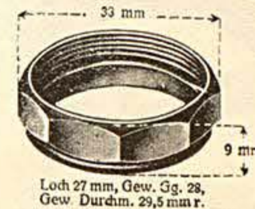
Nr. 13560 Für Dürkopp Loch 27 mm, Gew. Gg. 28, Gew. Durchm. 29,5 mm r.
