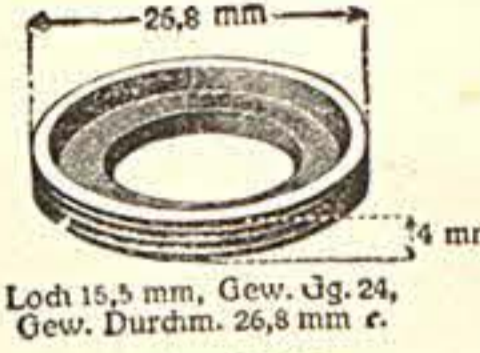
Nr. 13555 Für Dürkopp Loch 15,5 mm, Gew. Gg. 24, Gew. Durchm. 26,8 mm r.
