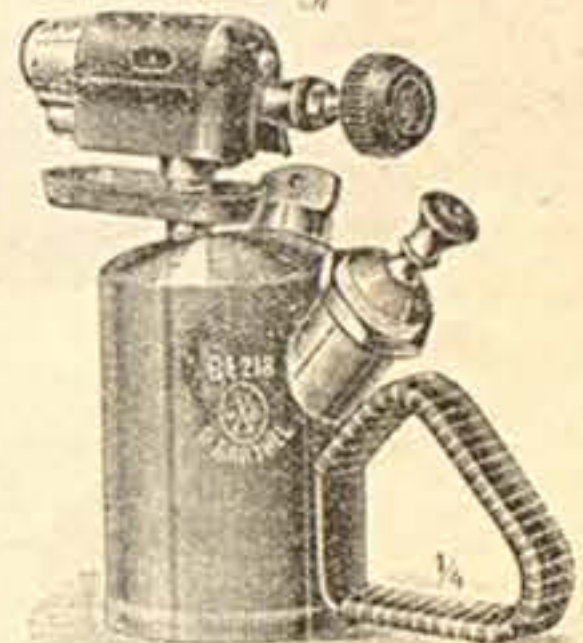
Nr. 6498 Benzin- und Benzol-Lötampe großes Modell mit Pumpe, für alle Hartlötarbeiten geeignet, mit poliertem Messingbehälter für 1 Liter Inhalt Brenndauer 50 Minuten
