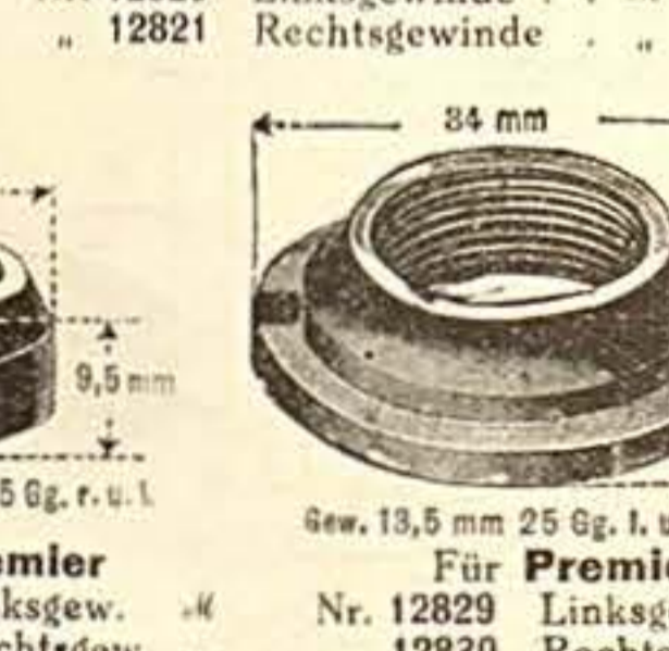
Gewinde 16,5 mm 25 Gg. r. u. l. Für Premier Nr. 12820 Linksgewinde . . . 12821 Rechtsgewinde . . .
