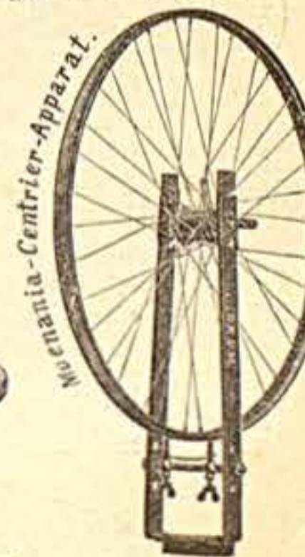
Nr. 6313 Zentrier-Apparat Bester und billigster Hilfs-Apparat, verstellbar für 24—30" Räder
