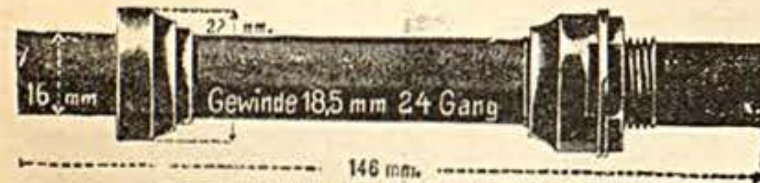
Nr. 10175 Für Finsterwalde (P. & B.) 140 mm lang, 27 mm Konendurchmesser
