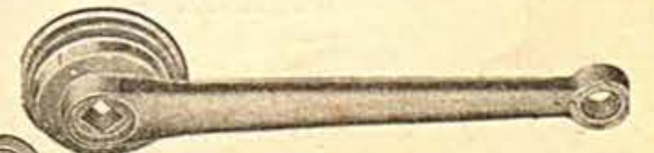
Nr. 8118 Rechte Kurbel, 53 mm Glockenweite, 58 mm Kettenradgewinde links
