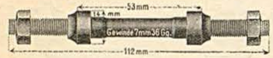
Nr. 10808 Für Brennabor, 112 mm lg., 53 mm Konenentfernung. 10839 " " 125 " " 62 " "
