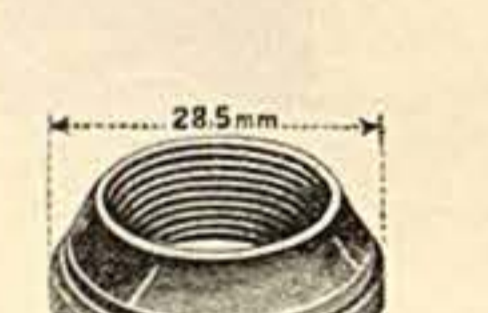
Gewinde 18 mm 26 Gg. l. Für Badenia Nr. 12524 mit Linksgewinde
