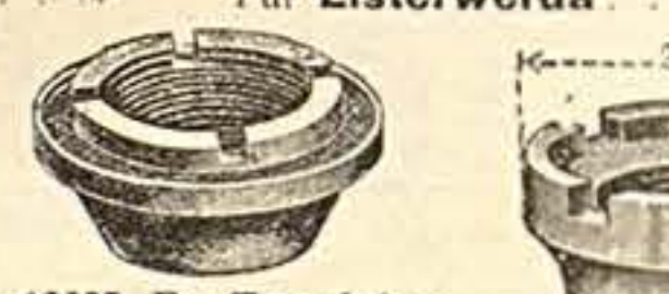
Nr. 12625 Für Excelsior mit Staubring, Gewinde 17,5 mm, 24 Gang links, 30 mm Durchmesser
