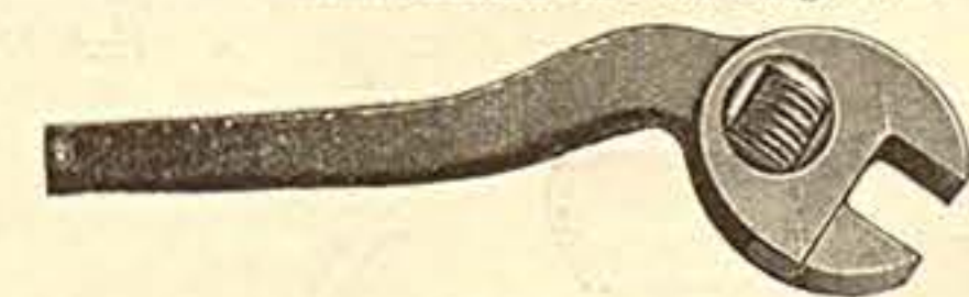
Nr. 6305 Knarrenschlüssel , am anderen Ende Lochschlüssel und Schraubenzieher. 130 mm lang
